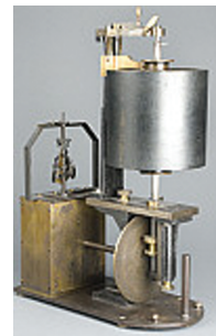
図 3 Ludwig-Baltzar 型カイモグラフ (http://dssmnhil.fas.harvard.edu/emuseumdev/html/media_enlarged_EN.html より引用)
