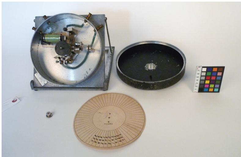
写真2 新潟大学に残る安藤研究所のランシュブルグの記憶検査器（カバーを外したところ）
