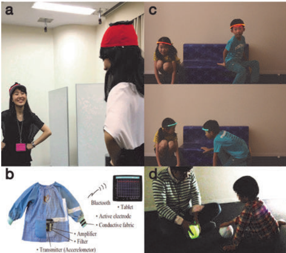
図2 (a) モーションキャプチャ・カメラシステム, (b) 着衣型心拍変動計測装置, (c) 対面行動を計測・拡張するウェアラブルデバイス, (d) 球体コミュニケーションデバイス「COLOLO」
