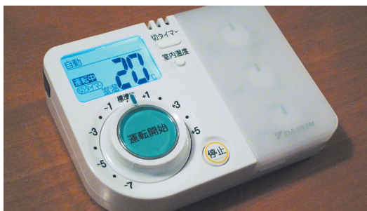
写真1 ダイキン工業（株）製エアコン「ラクエア」用リモコン（2012年発売）「人に聞かずに使えるリモコン」というコンセプトを科学的根拠によって実証したデザインが評価され、2012年グッドデザイン賞および2013年IAUDアワードプロダクトデザイン部門賞を受賞した。人間は自分の所有する家電機器の機能が少なくなることには大きな拒否感を示すので、わかりやすさとのバランスを図るために使用頻度の低いボタンを半透明のカバーで覆うという工夫をしたのが、このデザインの眼目である。
