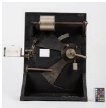
写真2 関西学院大学に残る「ネチャーフ式タキストスコープ」（ドイツ Zimmermann 社製）
