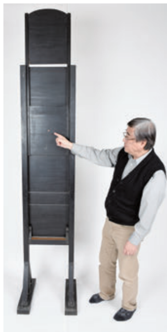
写真4 新潟大学に残る旧制新潟高等学校時代の「タヒトスコープ」（島津製作所製）。指をさしているところが注視点
