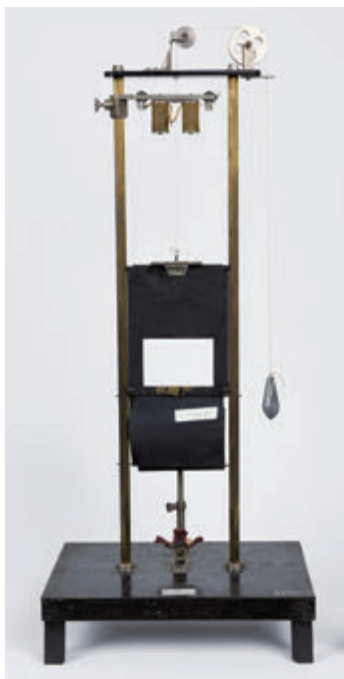
写真3 新潟大学旭町学術資料館に残る旧制新潟高等学校時代の「落下式瞬間露出器」（安藤研究所製）
