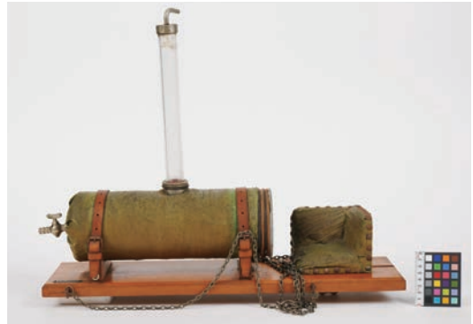
写真2 関西学院大学に残る「腕の容積脈波測定装置（レーマン式）」(KG000020 E.Zimmermann 製)
