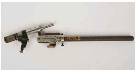
写真3 東京大学に残る喉音記録器 (TK00006 E.Zimmermann 製)
