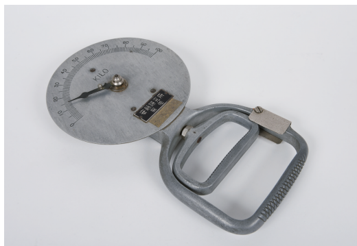
写真1 新潟大学に残る安藤研究所製のスメッドレー式握力計
