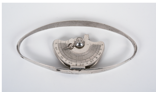
写真2 新潟大学に残る島津製作所製のコリン式握力計
