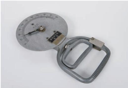
写真1 新潟大学に残る安藤研究所製のスメッドレー式握力計
