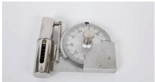
写真5 新潟大学に残る島津製作所製のカツテル氏指力計
