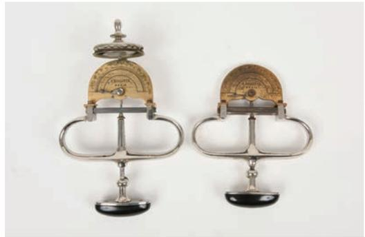
写真3 東北大学に残るパリにあるBoulitte製のヴェルダンの握力計
