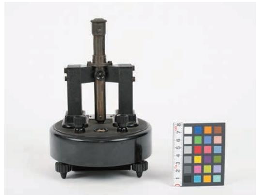
写真2 関西学院大学に残る反照検流計 (KG00010)
