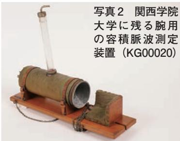
写真2 関西学院大学に残る腕用の容積脈波測定装置 (KG00020)
