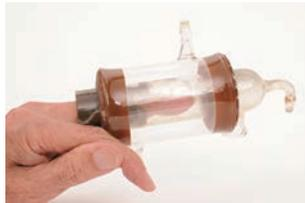
写真3 関西学院大学に残る指用の容積脈波測定装置 (KG00007)
