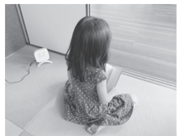
図1 非接触での心拍測定の様子 小型装置 (15 cm四方) にミリ波アレーレーダや信号処理部などを搭載。レーダーから10 cm程度の距離までの複数の対象者を同時に測定できる。
