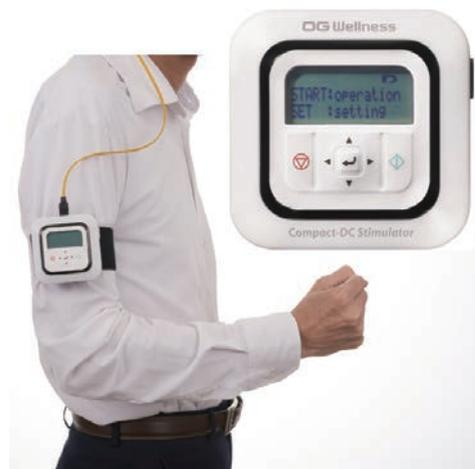
図3 ウェアラブル経頭蓋直流電気刺激装置（オージー技研株式会社との共同研究開発）
