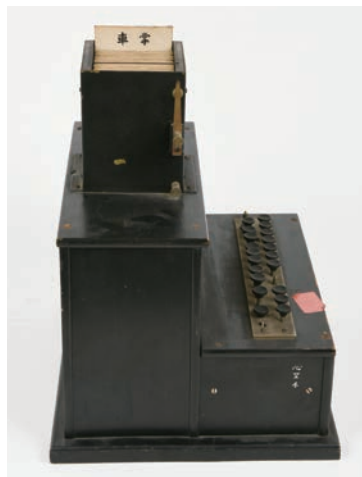
写真4 東北大学に残るZimmermann社製のタイプボード式カード提示器
