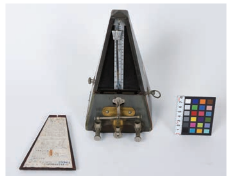
写真2 電流断続装置付き拍節器 (竹井製作所製, 新潟大学蔵)
