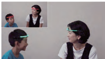
図2 FaceLooks 対面行動を計測するデバイス 3
